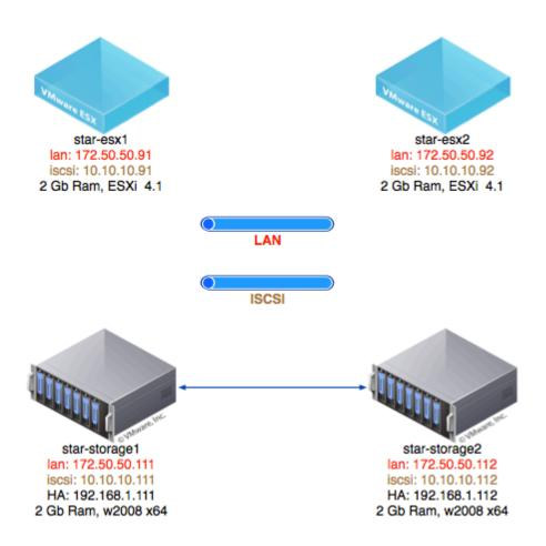
Sono state create tre reti separate per gestire e segmentare i vari tipi di traffico:
